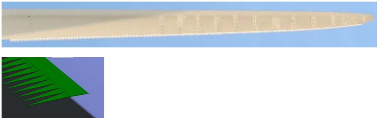
Figure 6 : Serration (photo et schéma) Sources : Vestas
